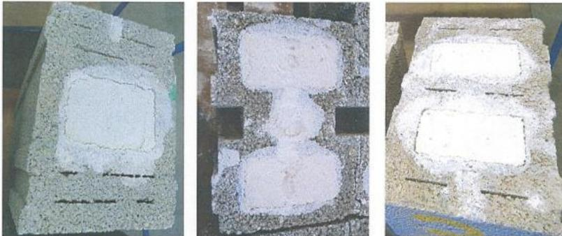
Bild 13: Prüfgegenstände (v.l.n.r. KLB Produkt Typ I, Typ II, Typ III)
