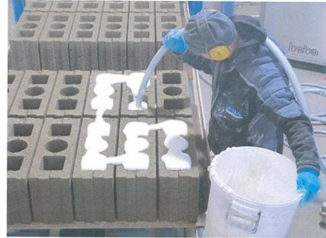
Bild 5: Befüllung der Steine direkt nach deren Fertigung
