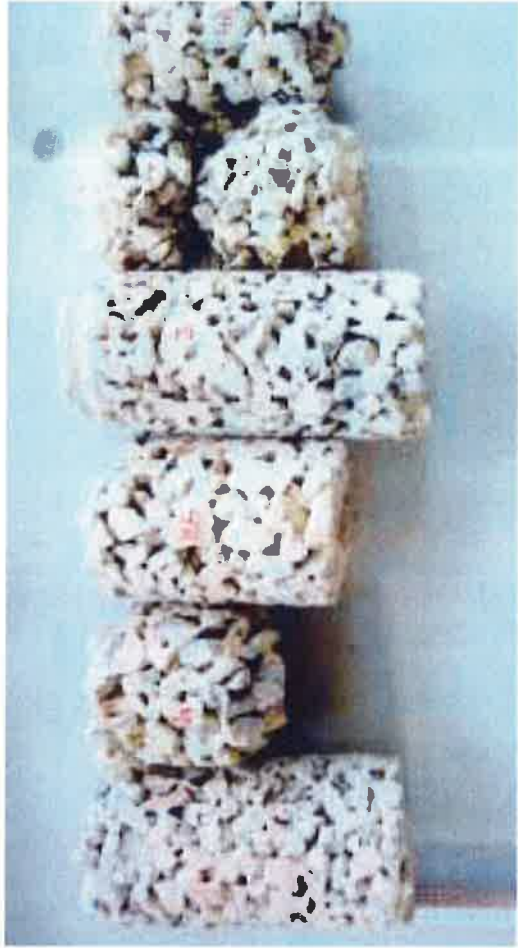
Entnommene Bohrkern Detail Ziegelsplittbeton
