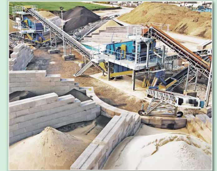
Der Aufbau erfolgt auf befestigten Flächen (gepflastert, asphaltiert, betoniert). Das Versetzen erfolgt mit Kranklammer oder Blockklemme.
