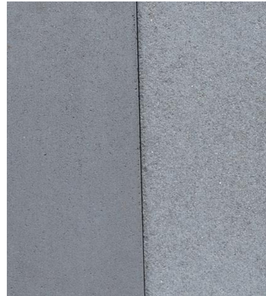
Abb. 5: links – nur gebürstet, rechts – Soffliner mit Bürsten
