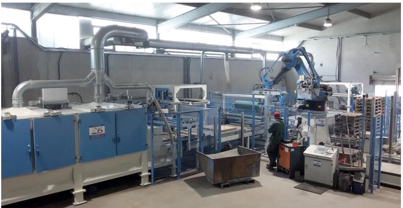
Abb. 6: Bürstenmaschine mit Paketieranlage
