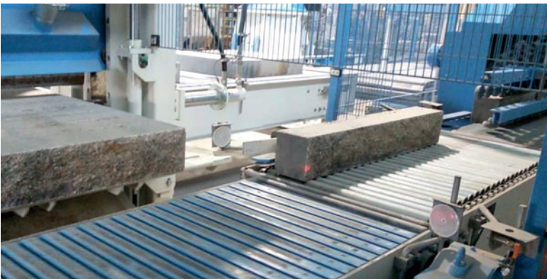
Abb. 7: Spaltmaschine mit Einlauf in den Softliner-wall
