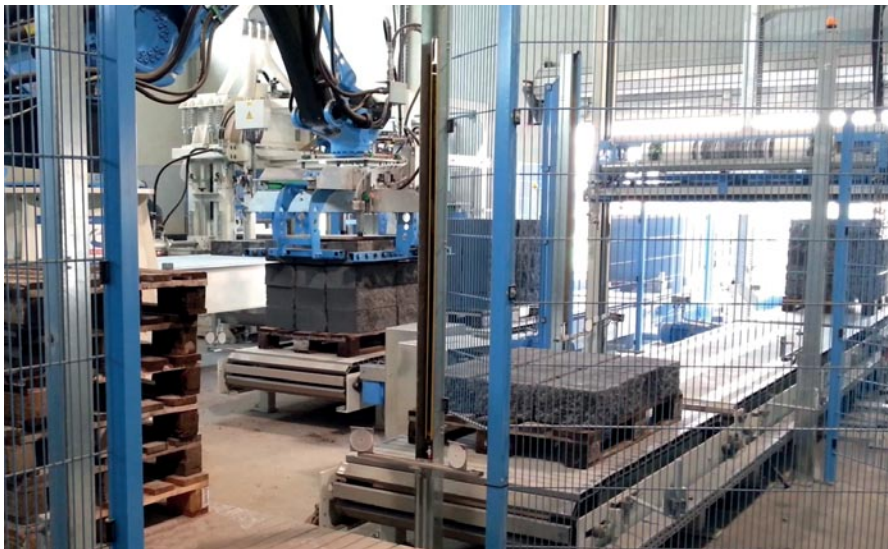
Abb. 10: Eingabe der Rohlinge für 2. Spaltung mit Nachbearbeitung
